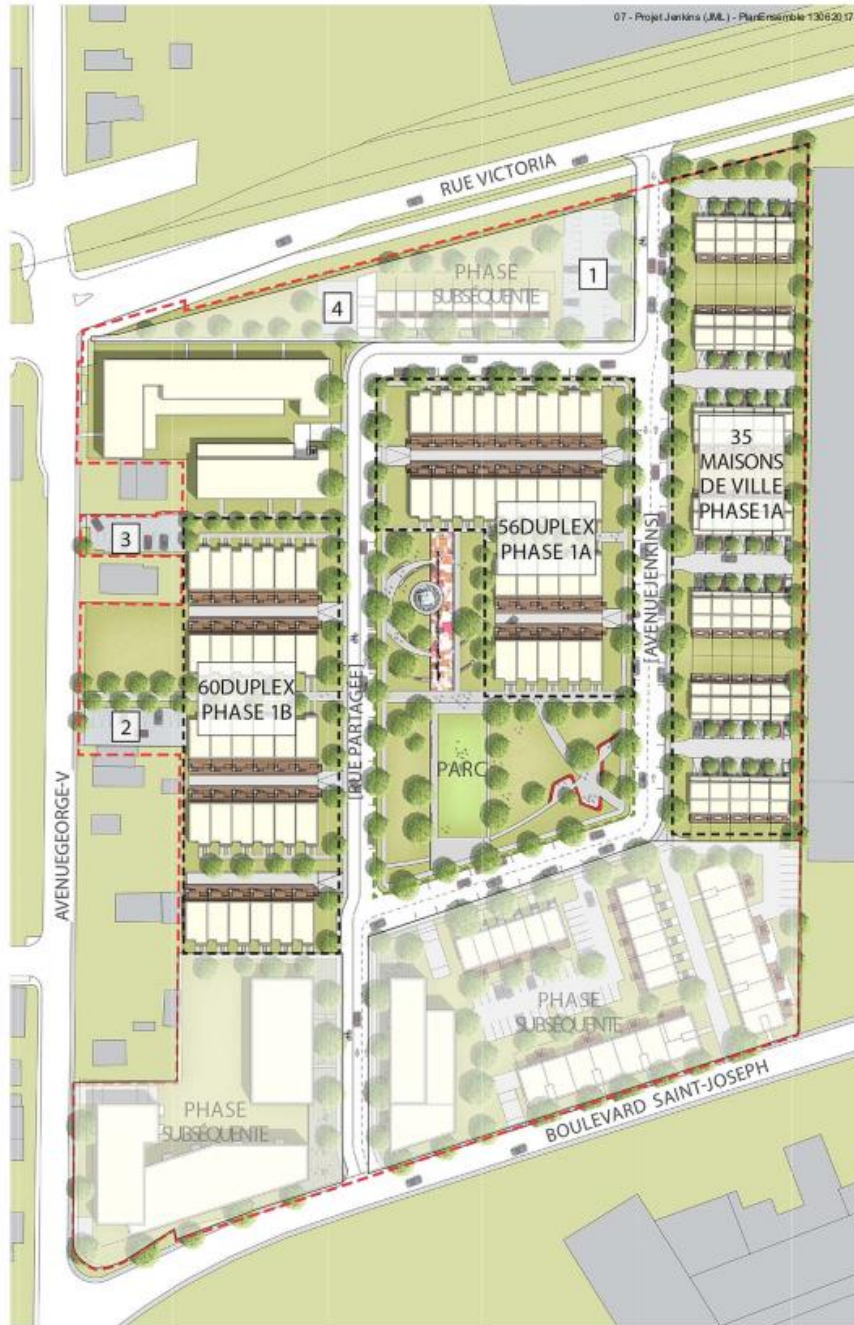
B PLAN D'ENSEMBLE DU PROJET JENKINS | PHASE 1 1 STATIONNEMENT 1 : 30 CASES 2 STATIONNEMENT 2 : 12 CASES 3 STATIONNEMENT 3 : 12 CASES 4 STATIONNEMENT 4 : 4 CASES --- SITE DU PROJET JENKINS --- DÉLIMITATION DE LA PHASE 1 Émis le 2017-06-13 15-0000_GroupeJIL_Jenkins lemay
