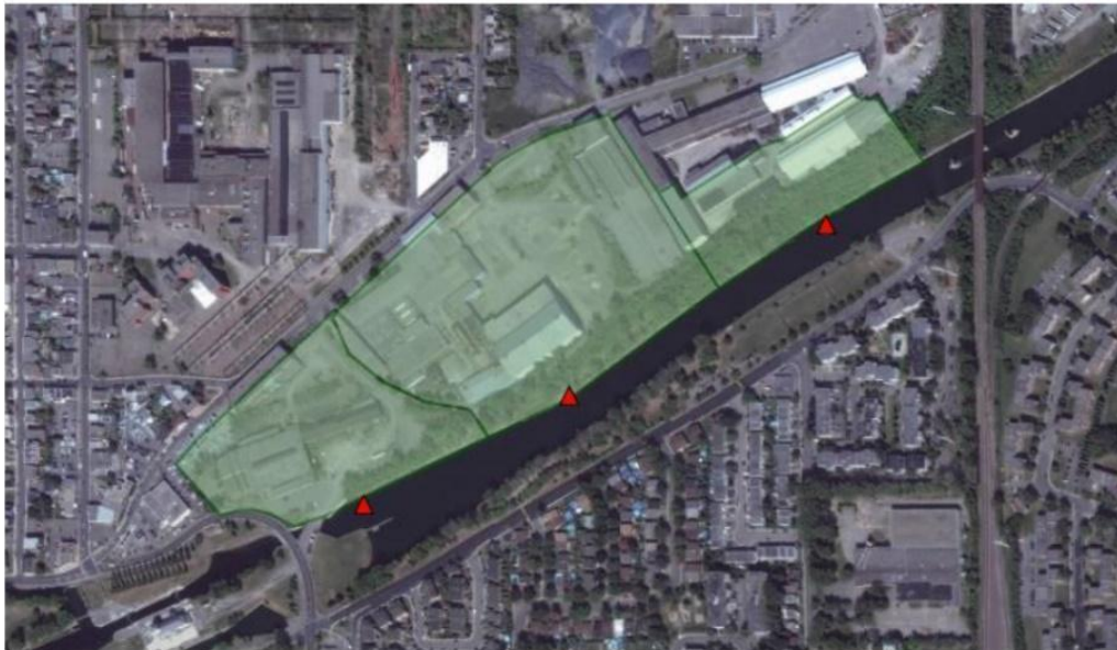
Figure 2.5 : Emplacement des trois émissaires désormais fermés et surface antérieurement drainée par ceux-ci
