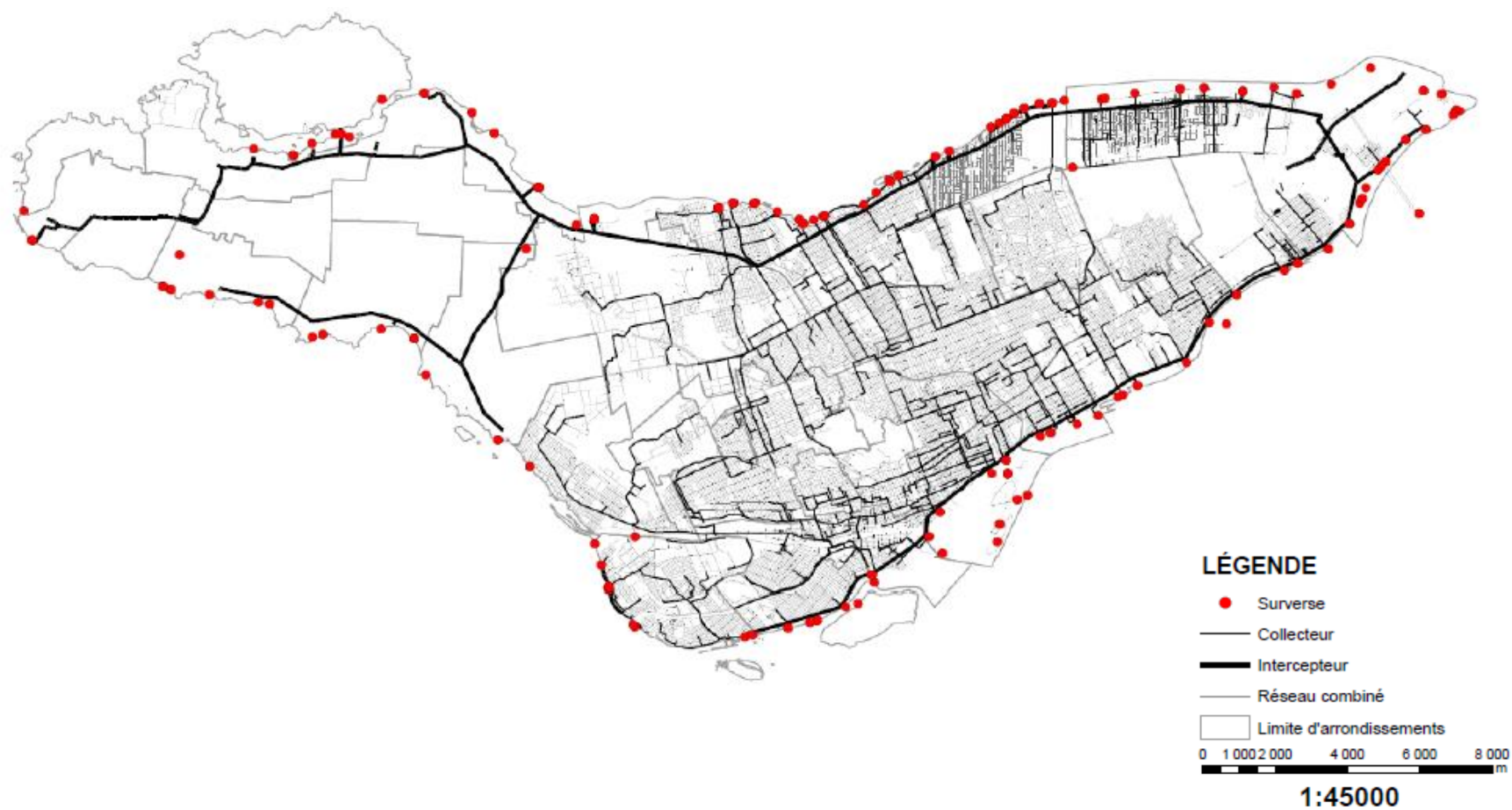
Figure 2.13 : Ouvrages de surverses et principales conduites du réseau unitaire de la ville de Montréal Source : Ville de Montréal 2015
