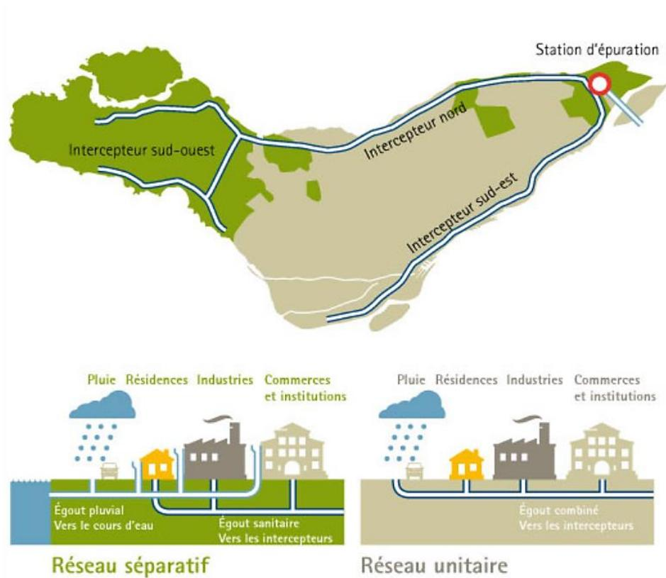
**Figure 2.9 : Intercepteurs, station d'épuration et portions de l'île desservies par un réseau unitaire et par un réseau séparatif**
